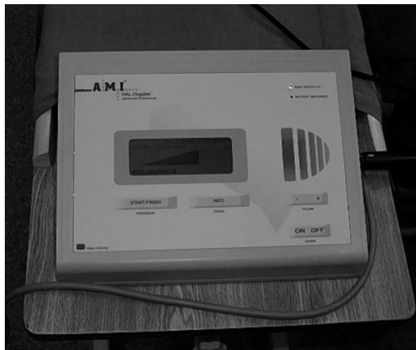
Fotografia 2 System odbiorczy i przetwarzający impuls fali przepływowej na efekty dźwiękowe i wizualne (A.M.I.® HAL-DOPLER). Signal receiver transforming flow wave signal into video and audio effects.
